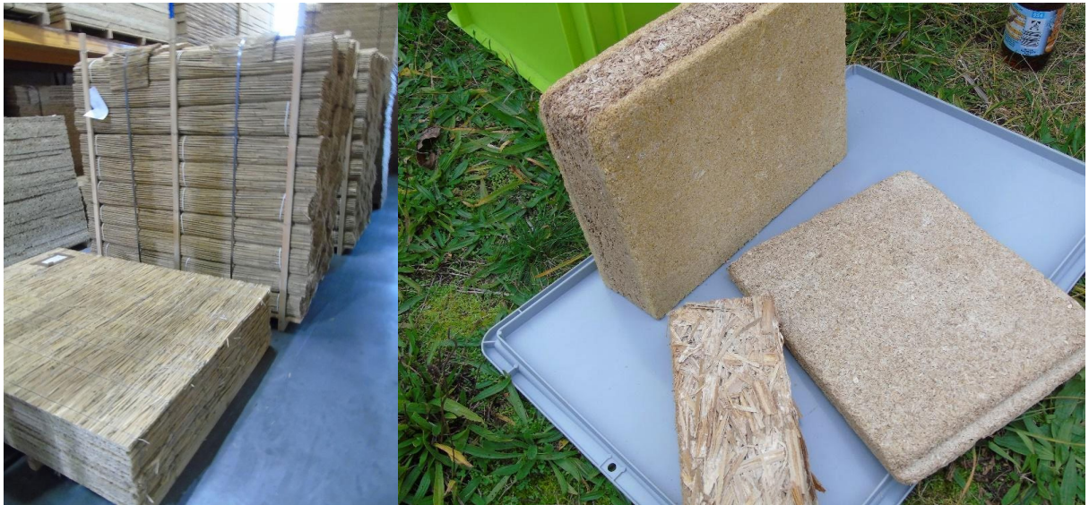
Kilimėlių iš paprastųjų nendrių (kairėje) ir izoliacinių plokščių iš švendrių bei nendrių (dešinėje) gamyba. Brandenburg, Vokietija. Łukasz Mucha nuotr.
